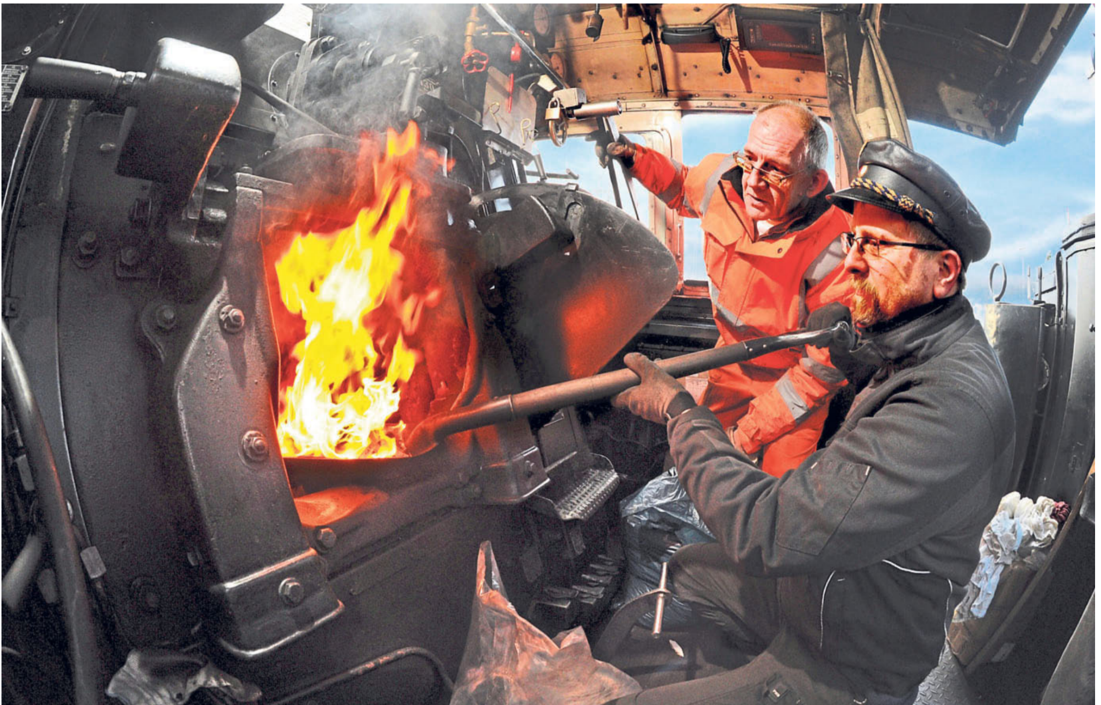
Heiße Sache: Marco Riffelmann (rechts) und Dietmar Plischke entzünden mit der lodernen Schaufel das Kesselfeuer. Fotos: Bernhard Pierel
